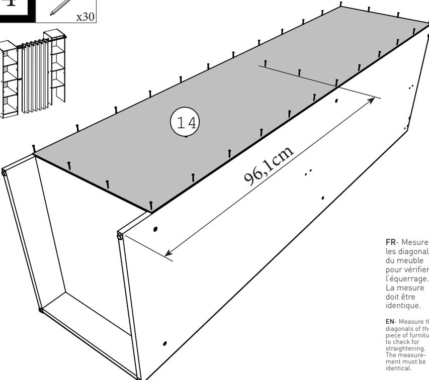
**FR-** Mesurer les diagonales du meuble pour vérifier l'équerrage. La mesure doit être identique.
