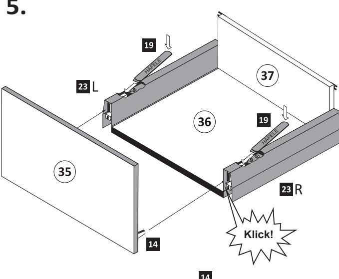
Führen Sie die Schubkastenblende (35) mit dem Beschlag (14) wie abgebildet in die Zargen ein. Der Beschlag (14) rastet ein !
