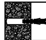
Beiliegendes Befestigungsmaterial eignet sich nur für Massivwände.
